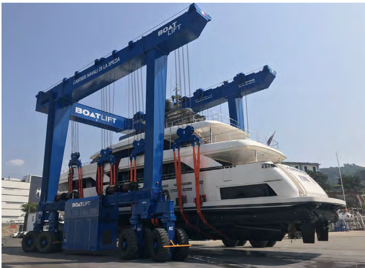
Figur 4: Eksempel på båtheis fra leverandøren Boatlift.
