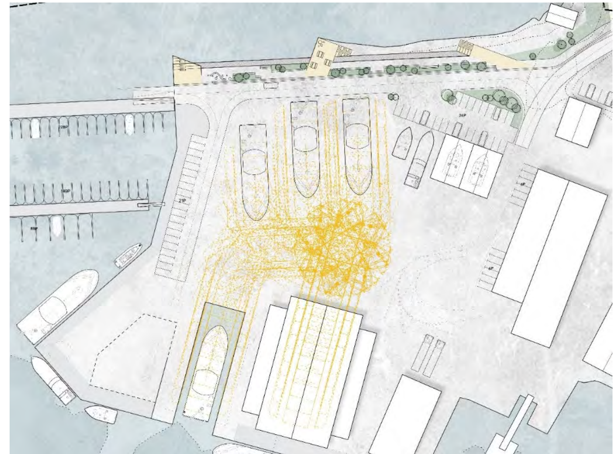
Figur 5: Utsnitt av illustrasjonsplan med bevegelseslinjer for båtheis markert med gult. Det er satt av areal foran sliphallen til manøvrering av båtheisen.
