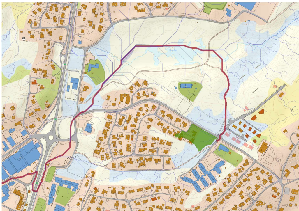
Figur 7: Oppstrøms nedbørsfelt og naturlige strømningslinjer for Torvhaugan omsorgsboliger nordøst hentet fra SCALGO. Mørkegrønt område viser nedbørsfelt, rød linje viser strømningslinjer.
