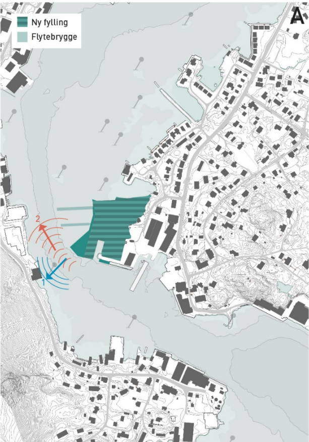
Figur 7: Til venstre: A:Påvirkning av bølgeforhold lokalt. Figur 8: Nederst til venstre: B: Bølgeforhold eksisterende situasjon. Figur 6: Nederst til høyre: B: Bølgeforhold ny situasjon.
