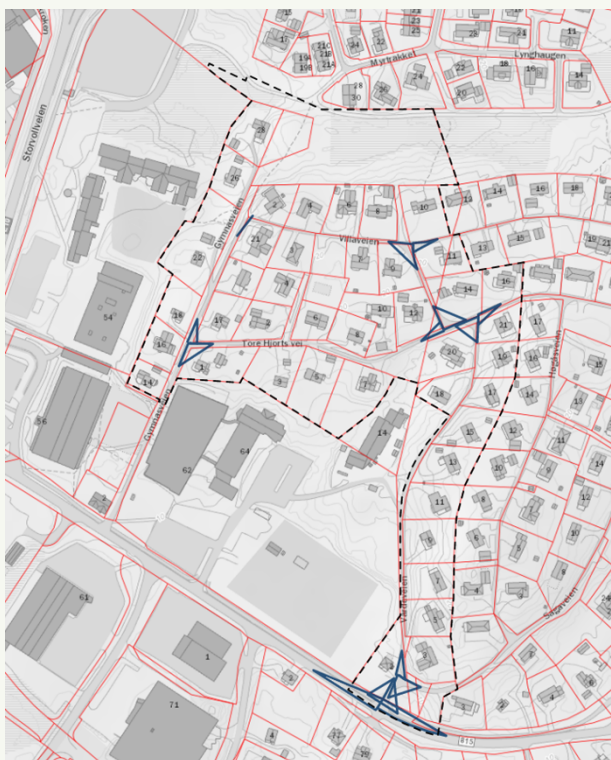
Figur 6-7: Anbefalte frisiktsoner i kryss i planområdet. Alle siktlinjene avsettes i planforslaget bortsett fra siktretrekanten mellom Tore Hjorts veg og søndre del av Gymnasveien, som blir noe redusert ettersom vegen avsettes til gatetun.
