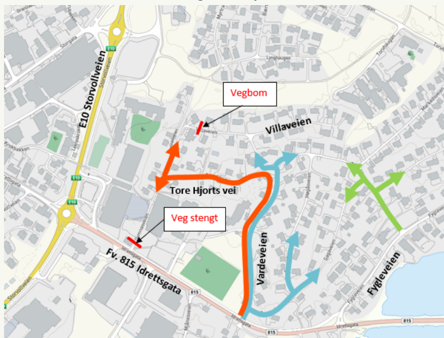
Figur 5-9 Midlertidig kjøremønster i planområdet under anleggsperioden Lekneshallen
