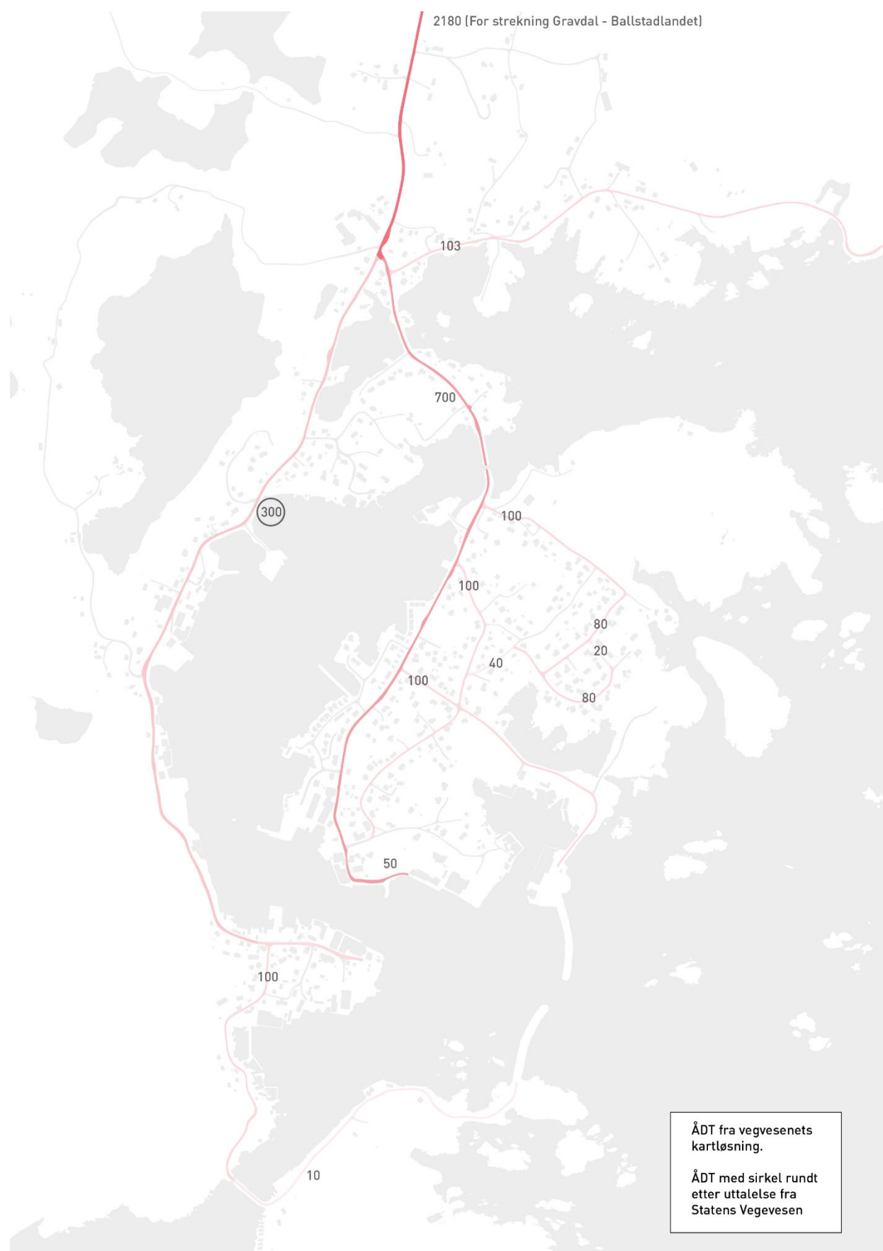
Figur 9: ÅDT på Ballstad – Eksisterende situasjon.
