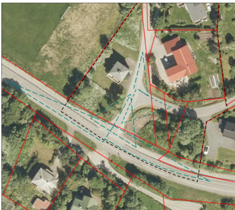
Figur 2-8 Siktforhold i kryss Idrettsveien x Vardeveien. Blå stiplede linjer viser sikttrekant ihht vegnormalen.
