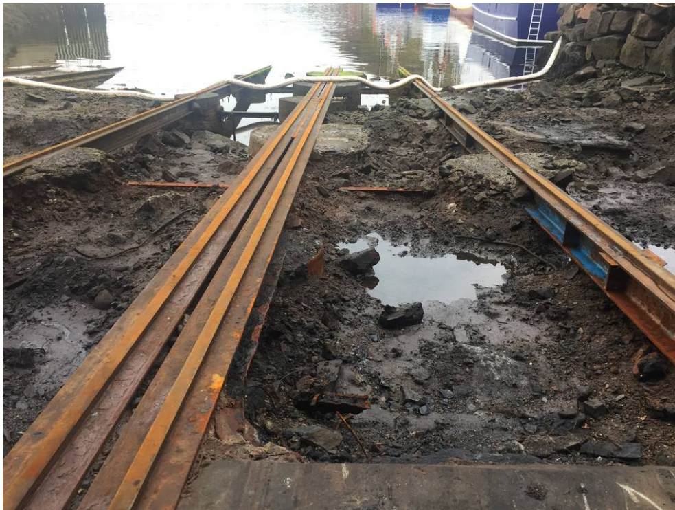
Foto 4: Prøvepunkt 3 – Bløte masser (jord/sediment), grus, stein, og noe blokk. Massene lukter noe olje + nedbrutt organisk, svarte masser noen steder,
