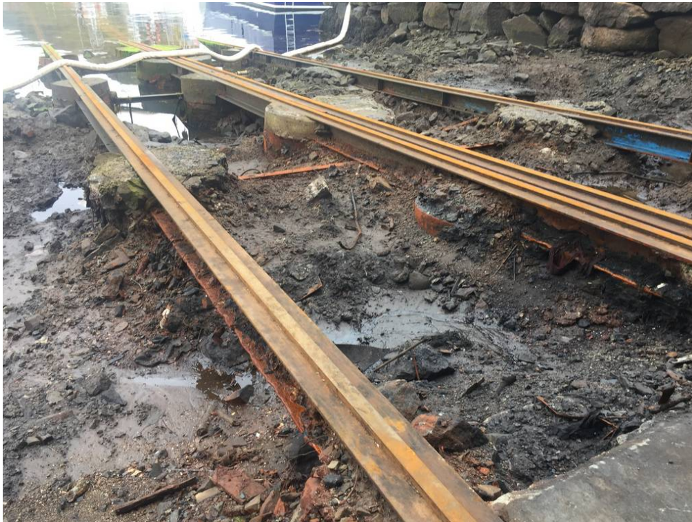
Foto 3: Prøvepunkt 2 – Bløte masser (jord/sediment), grus, stein, og noe blokk. Massene lukter noe olje + nedbrutt organisk, svarte masser noen steder,
