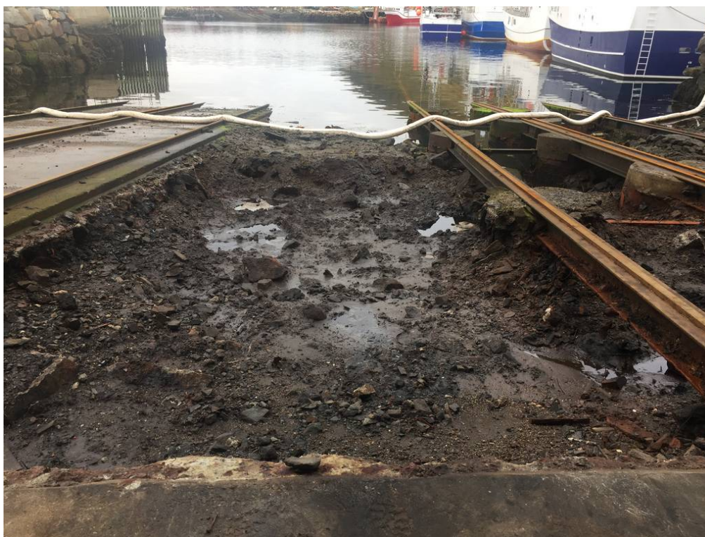
Foto 2: Prøvepunkt 1 - Bløte masser (jord/sediment), grus, stein, og noe blokk. Massene lukter noe olje + nedbrutt organisk, svarte masser noen steder, oljefilm på vannet.
