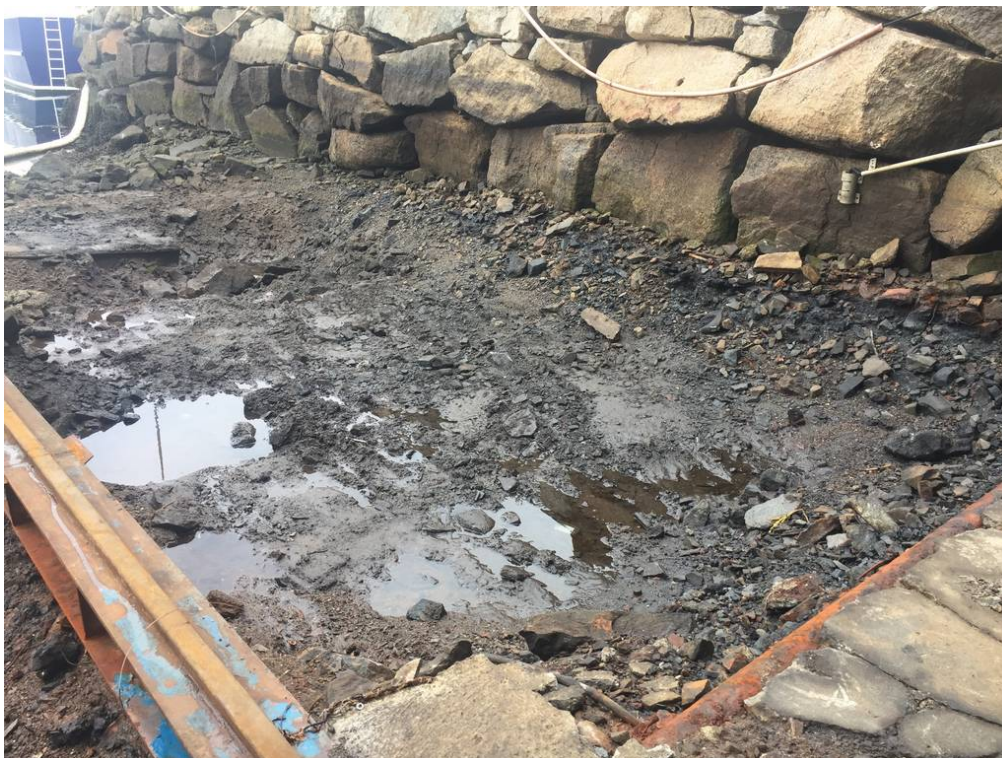
Foto 5: Prøvepunkt 4 – Bløte masser (jord/sediment), grus, stein, og noe blokk. Massene lukter noe olje + nedbrutt organisk, svarte masser noen steder,
