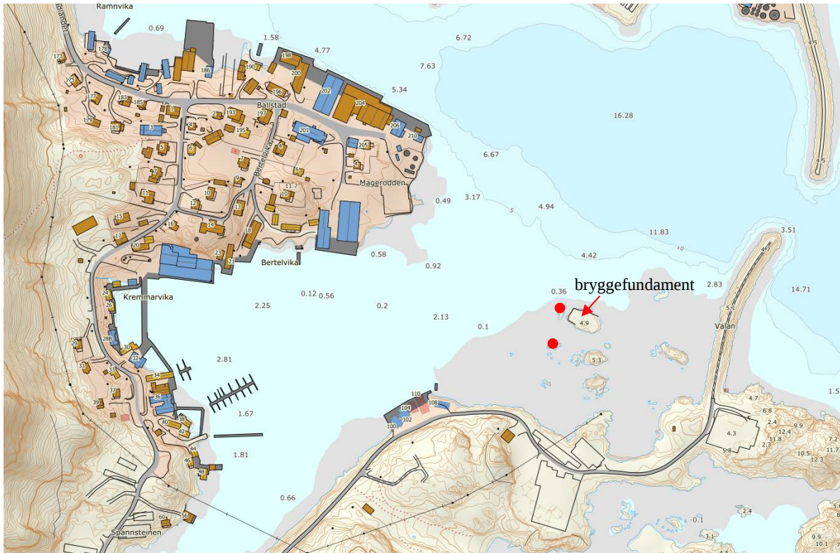
Figur 2. Kart over sørlig Ballstad havn med dybdekoter i sjøen som viser lokalisering av bryggefundament og fortøyningsbolter i utfyllingsområdet ved Gjermesøy.
