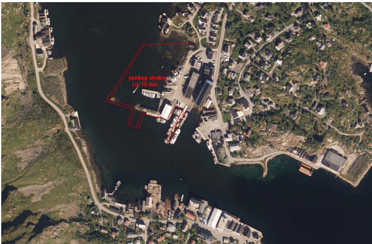
Ortofoto med inntegnet utfylling på ca. 16 daa, som strekker seg helt til skjæret midt i havnebassenget:
