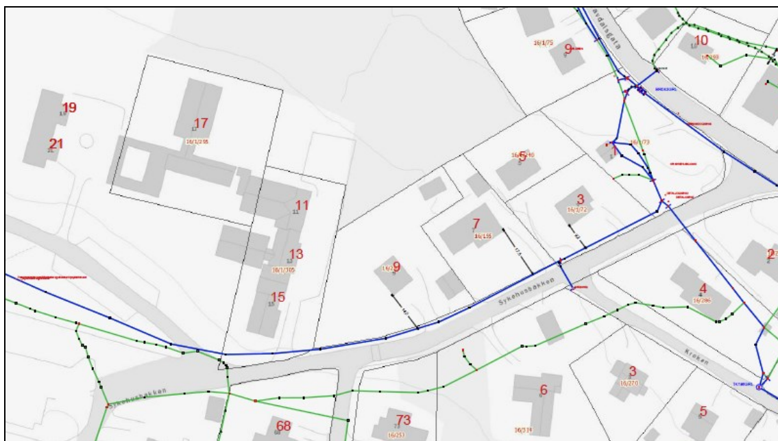
Fig 9 Kabeloversikt telekabler fra Telenor
